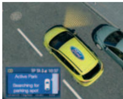
que elegir la primera o la marcha atrás y el coche hace el resto. Del volante se encarga el sistema electrónico de dirección asistida, con sus sensores.
