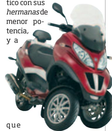
que comparten elementos como las suspensiones, los frenos o la carrocería. Pero a diferencia de la versión de 400, incorpora un propulsor de 493 centímetros cúbicos. Esta mecánica le otorga 40 caballos, en una combinación con la que consigue alcanzar una velocidad de 145 kilómetros por hora. Tenemos como resultado una motocicleta con una rápida respuesta en la ciudad y regular en grandes vías.
