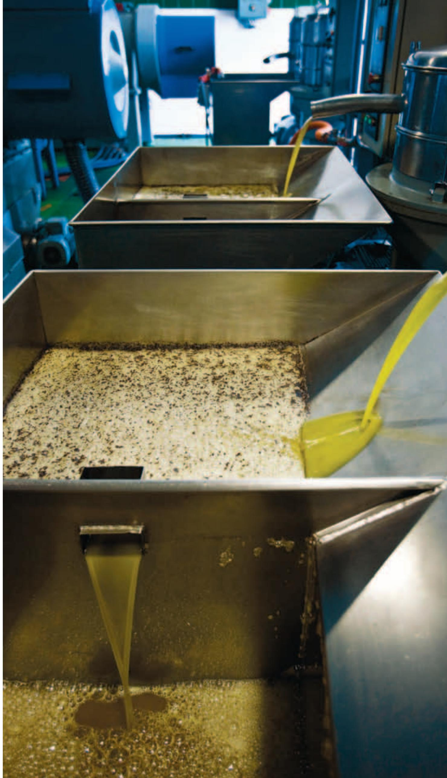
Seguidamente, la pasta obtenida es centrifugada para separar los elementos líquidos de los sólidos y, por decantación, el agua del aceite, siempre por procedimientos mecánicos, es decir, sin recurrir a métodos químicos ni térmicos. El aceite obtenido es filtrado para eliminar la materia orgánica en suspensión.
