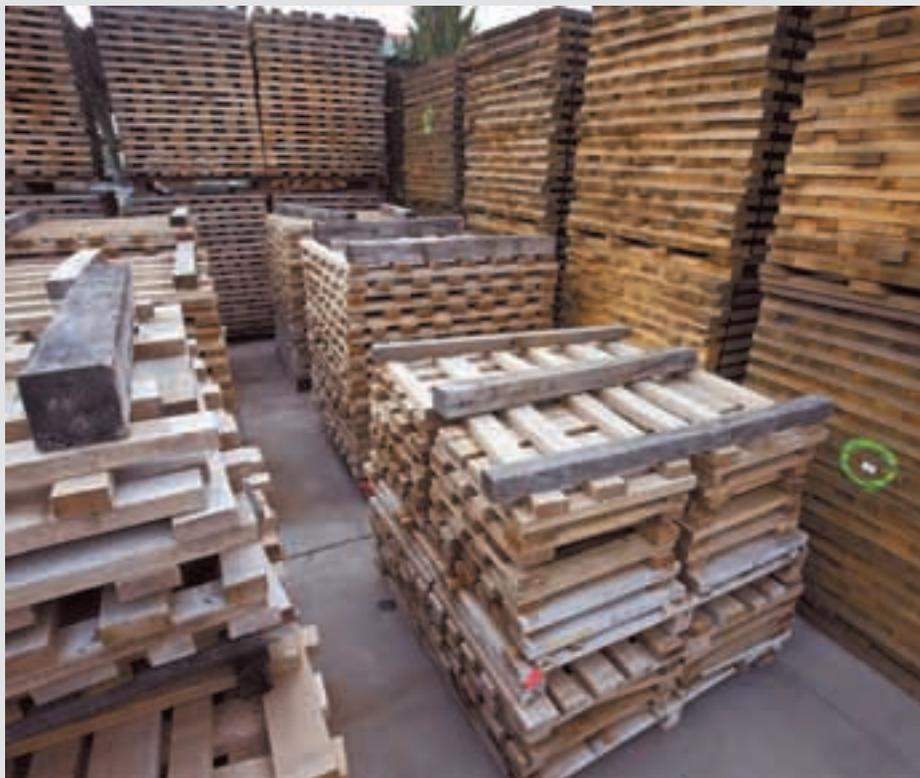
**1** El curado de la madera se completa en las propias instalaciones de la tonelería. Al aire libre y sometidas a la acción de los agentes atmosféricos, las tablas de roble seleccionadas en origen van perdiendo en este proceso sus amargores naturales y hasta un 15 por ciento de humedad.
