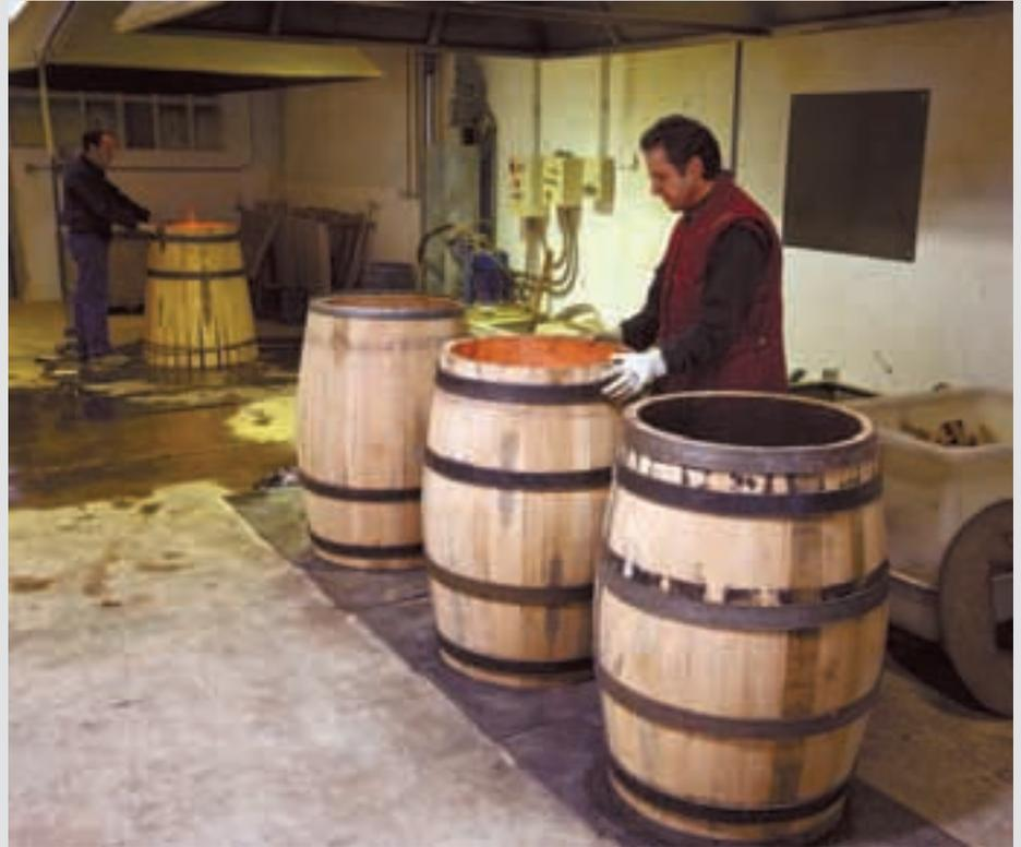
**4** Una vez concluido el tostado, se colocarán los fondos y los aros de hierro serán sustituidos por flejes de acero galvanizado. Tras un lijado general y la apertura de la boca en la *barriga* (orificio de llenado), la barrica está terminada. Ya solo falta grabar el nombre del cliente con rayo láser.
