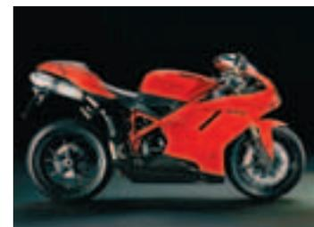
pulsor bicilíndrico suma seis nuevos caballos hasta alcanzar los 140. Es una moto manejable, entre otras razones por la reducción de su peso hasta los 168 kilos.
